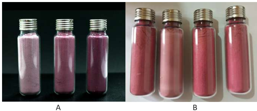
Fotografía 3. Almidones obtenidos a partir de tubérculos de ñame morado ( Discorea trifida var. Morada). A. Sin modificar (estándar, precipitada y centrifugada) y modificada (ácido fuerte, ácido cítrico, enzimática y ultrasonido). Fuente: Proyecto SGR-Vaupés- Instituto SINCHI- William Quintero-Contratista, 2022.
