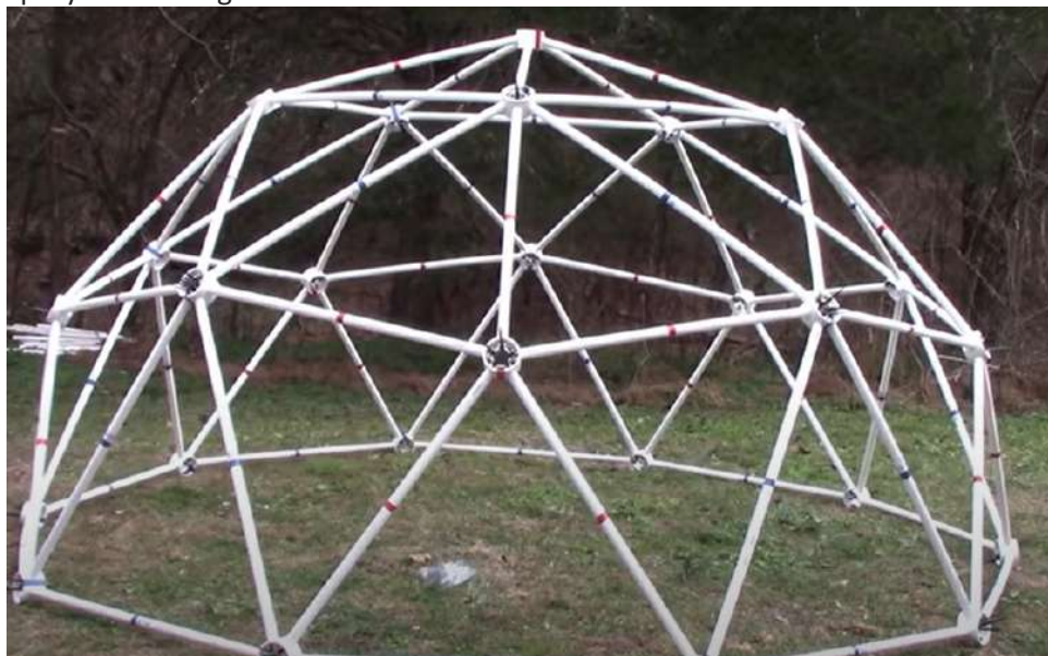
Fotografía 1. Secador geodésico diseñado para la deshidratación de materias primas en la comunidad de Wacurabá. Fuente: Proyecto SGR-Vaupés- Instituto SINCHI-Luis Eduardo Mosquera-Contratista, 2022.
